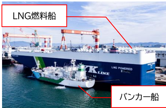
【(図表⑦)バンカー船によるLNGの燃料供給の様子】[提供:セントラルLNGマリンフューエル]
