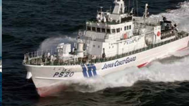
PS 型 (180トン型) 巡視船しんざん 全長：46.0メートル 最大幅：7.5メートル 総トン数：195トン
