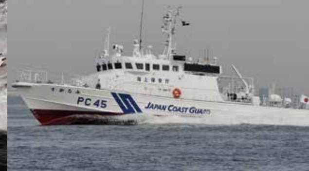
PC 型 (23メートル型) 巡視艇すがなみ 全長：27.0メートル 最大幅：5.6メートル 総トン数：64トン
