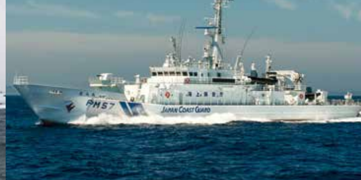
PM 型 (500トン型) 巡視船そらち 全長：72.0メートル 最大幅：10.0メートル 総トン数：650トン
