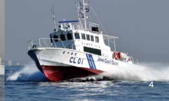
CL 型 (20メートル型) 巡視艇さつかぜ 全長：20.0メートル 最大幅：4.5メートル 総トン数：26トン
