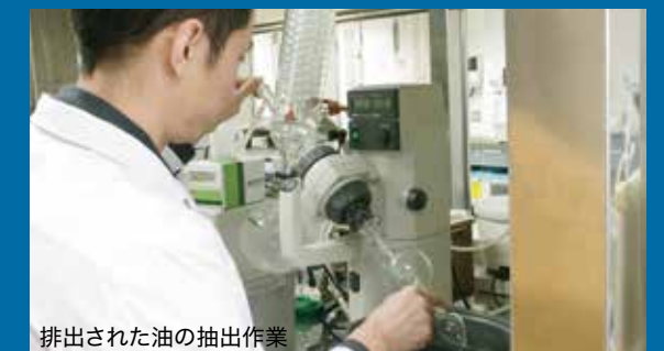
排出された油の抽出作業
