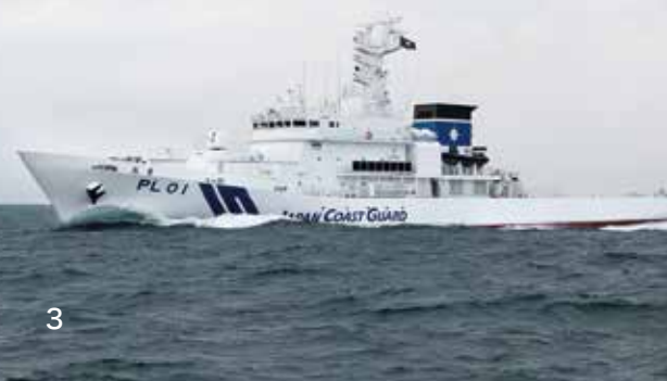
PL 型 (1,000トン型) 巡視船おき 全長：96.0メートル 最大幅：11.5メートル 総トン数：1,500トン
