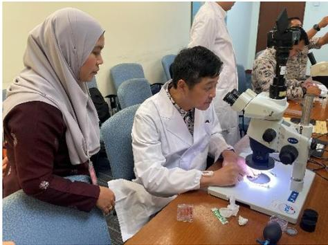
実体顕微鏡を使用した試料の調整
