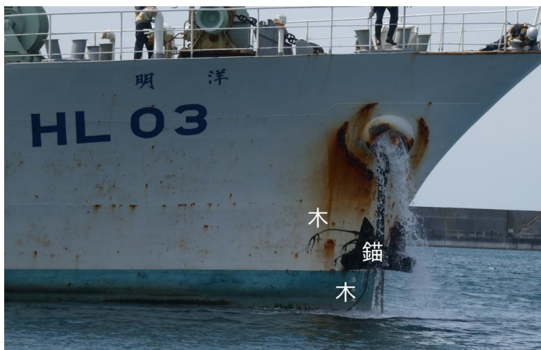
図7 測量船「明洋」が輪島港内で錨を抜いた際に絡まった木
