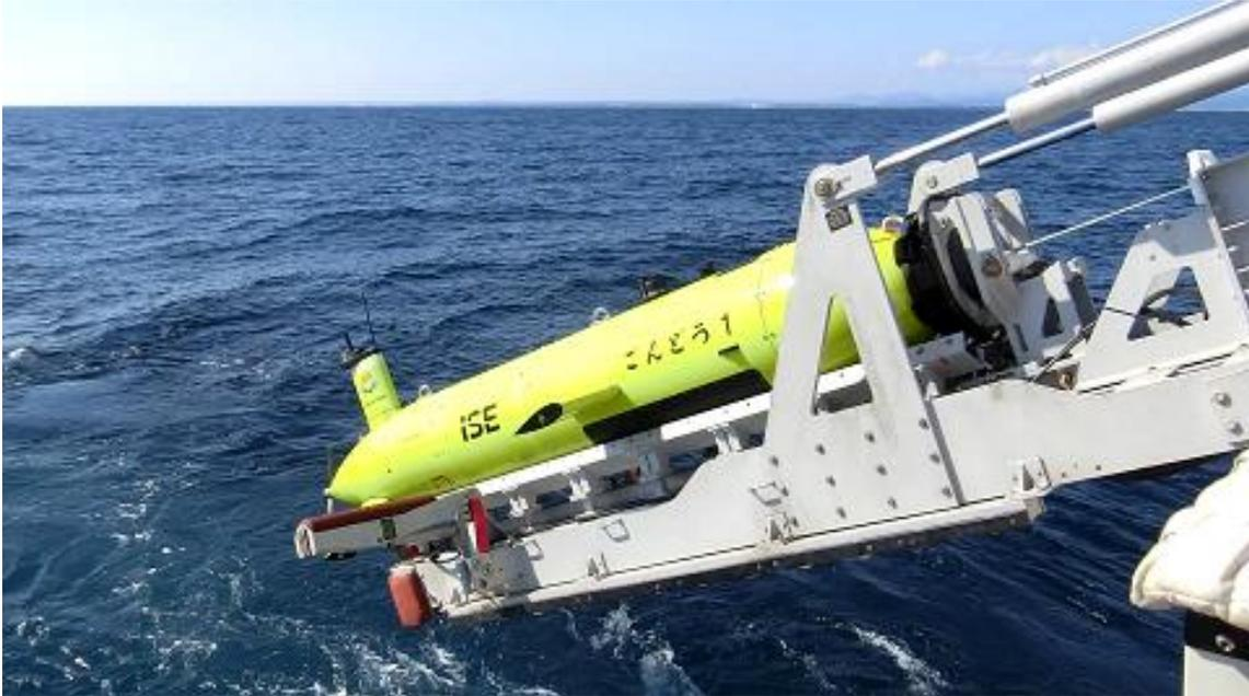
AUV はプログラムされた経路を自動で潜航して調査を行う機器。海底近傍まで潜航して調査を行うことで、詳細な海底のデータを収集することができる。
