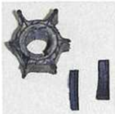
破損したインペラ
