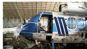
胴体下部水没、取卸エンジン水没一部損傷
