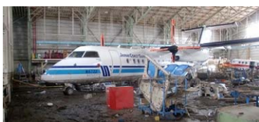
機内床下浸水、胴体一部破損
