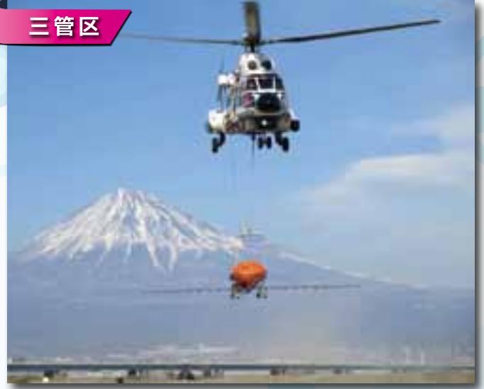
富士川滑空場における油処理剤 空中散布装置の運用訓練 (1月24日 第三管区海上保安本部)
