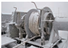
揚錨機は縦型から新しい横型に変更され、作業性が向上した。今は縦型は製造されていない。
