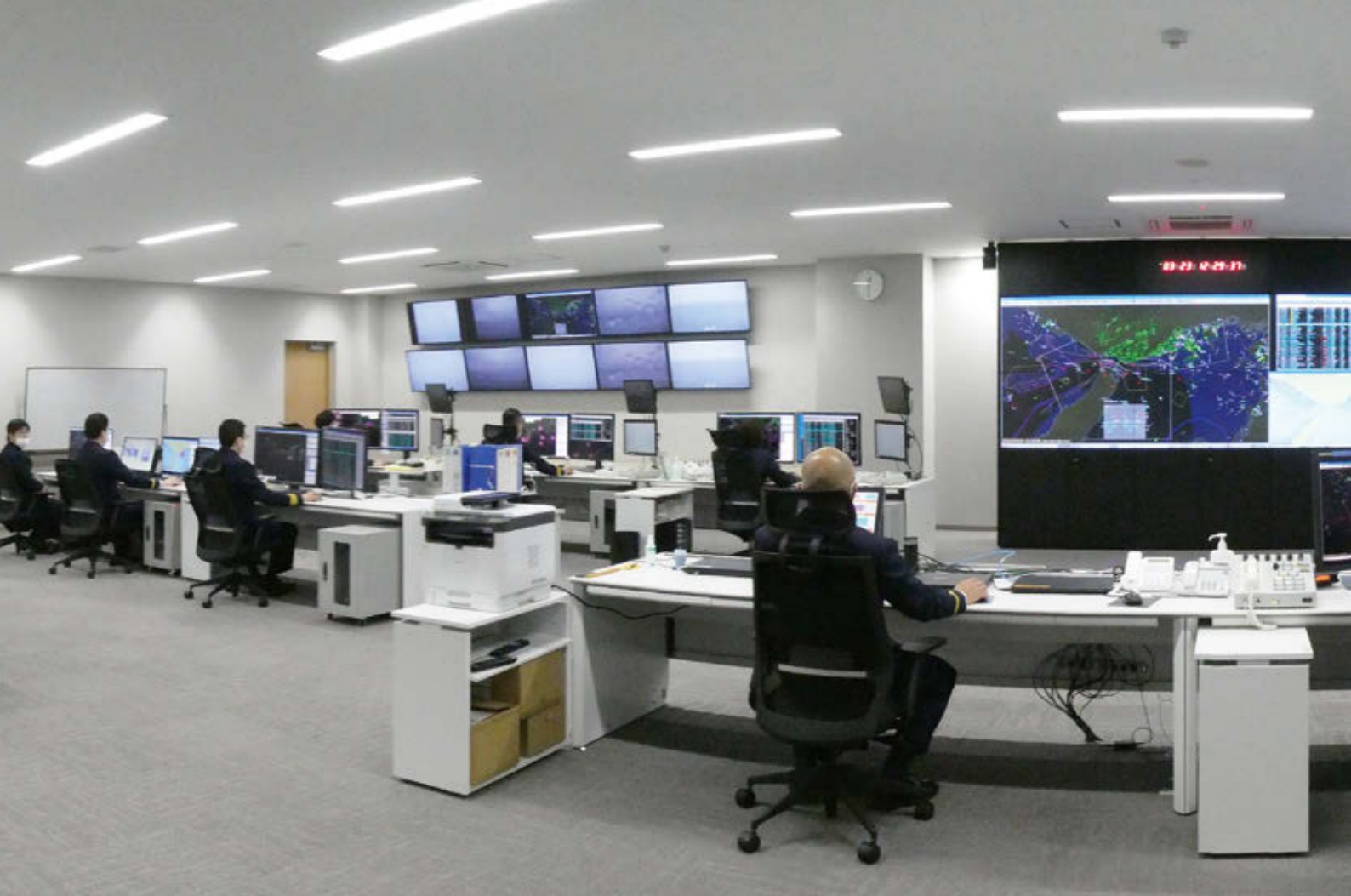
統括運用管制官が室内全体を見渡せる新庁舎の運用管制室。デスク及び壁面のモニターに映るITVカメラからの映像とレーダー、AISの情報を基に、ほぼリアルタイムで船舶の動静監視をしている
