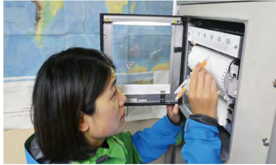
潮位計の確認
