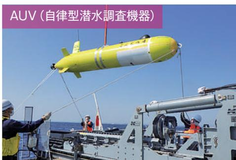
AUV (自律型潜水調査機器)
