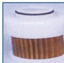
劣化した燃料 フィルタ
