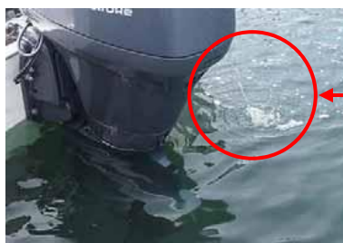
冷却水排出状況（船外機）
