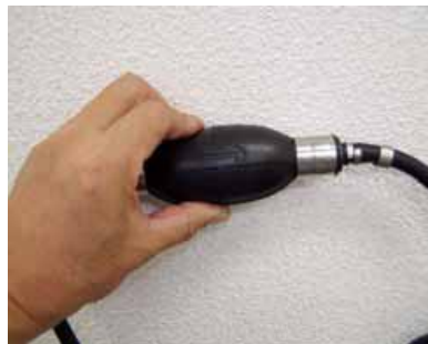
プライマリポンプ（船外機）
