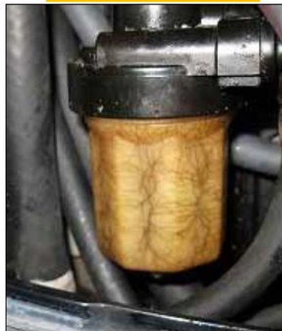
フィルタケースの劣化
