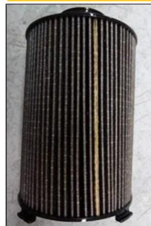
劣化したフィルタ
