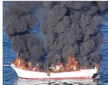
**燃料漏れ、潤滑油漏れ**…燃料や潤滑油が漏れて、排気管や過給機などの高温部にかかるると火災となります。各配管の漏れやこし器の緩みなどしっかり点検して、異常があればすぐに整備しましょう。
