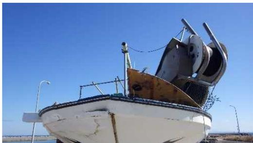
【見張り不十分が原因で衝突した漁船の損傷状況】
