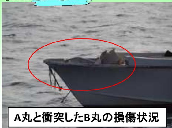
A丸と衝突したB丸の損傷状況
