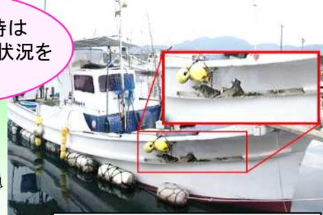
B丸と衝突したA丸の損傷状況
