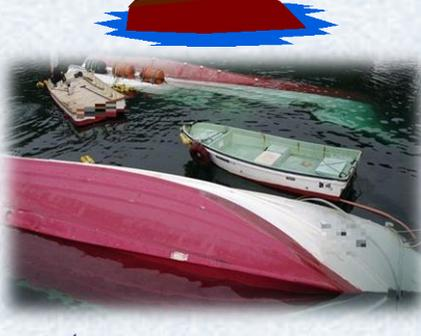
漁船B丸は係留中、船底の亀裂から浸水し転覆、またB丸に横付け係留していた漁船C丸も引きずられ転覆したものの。
