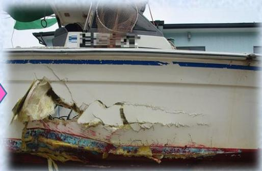
●漁船C丸は着岸中、係留索が磨耗により切れ、無人漂流状態となったもの。(係留索の切断防止措置不十分)
