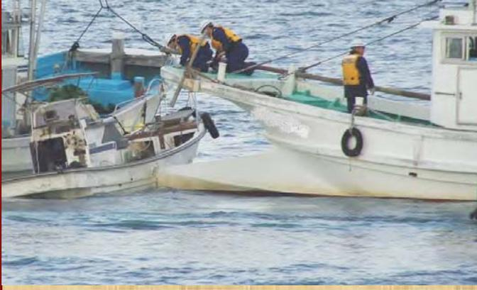
※この写真は、漁船A丸の船首が漁船B丸の側面に衝突して突き刺さっている状況です。
