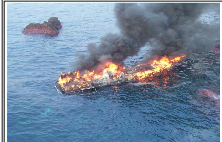
写真の船舶は出港時、燃料油が船底に漏れているのを確認していましたが、船底に溜まった油を陸揚げしないまま出港し、操業後帰港中に火、乗揚げたものです。
