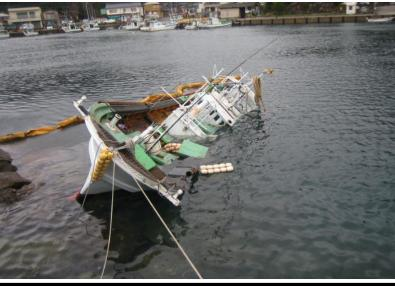
該船は船首から3本、船尾からアンカーロー 本を取り、船首着け状態で岸壁係留して 強風により船尾アンカーが走錨 付近岩場に乗揚げ浸水したものです。
