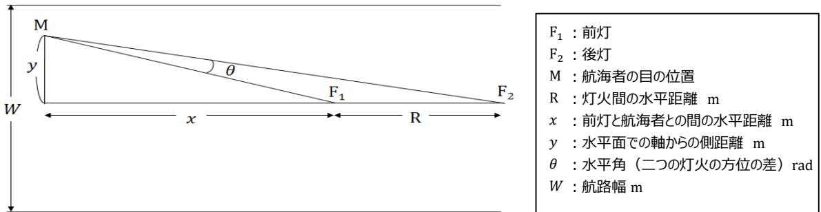
船舶が航路の中心軸から外れる方向に航行するとき、航海者が中心軸からのずれを確信をもって認知できる場合の2灯の最小水平角 $\theta_D$ 、その時の側距離 $y_D$ は、次の式から求めます。
