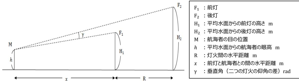
前灯によって生じる航海者の角膜照度 $E_1$ 、後灯によって生じる航海者の角膜照度 $E_2$ は、次の式から求めます。
