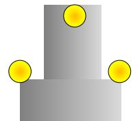
【例2】1 本灯は、橋脚基部の中央及び両隅に各1個設置されていて、3個の灯火は同期している。
