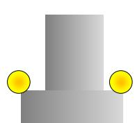
【例4】1 本灯は、橋脚基部の中央及び可航水域側に各1個設置されている。
