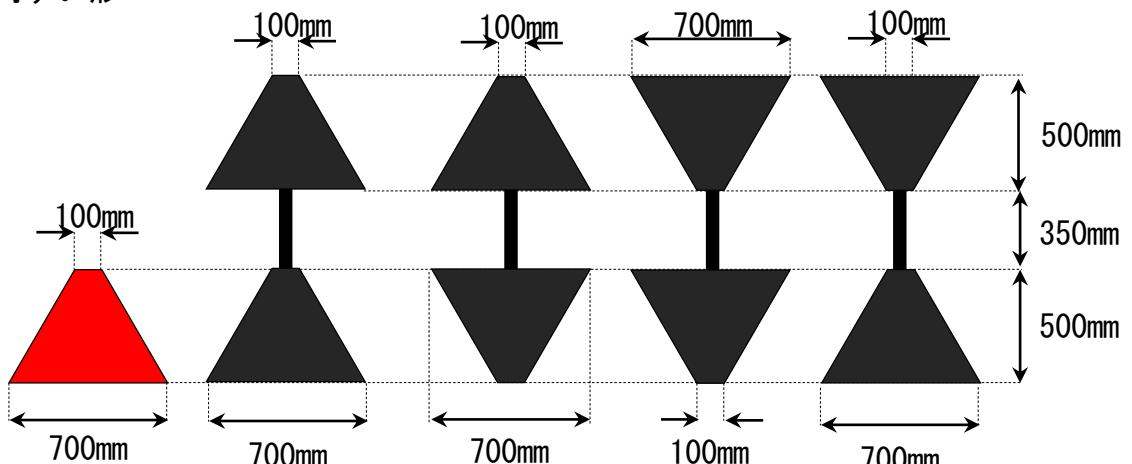
【右舷標識】 【北方位標識】 【東方位標識】 【南方位標識】 【西方位標識】
