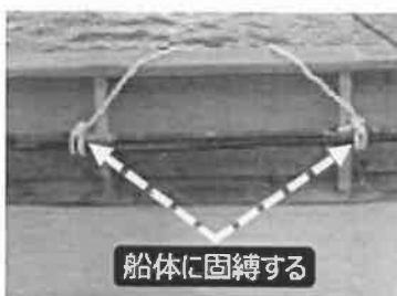
⑪ 索の末端を船内に固縛する
