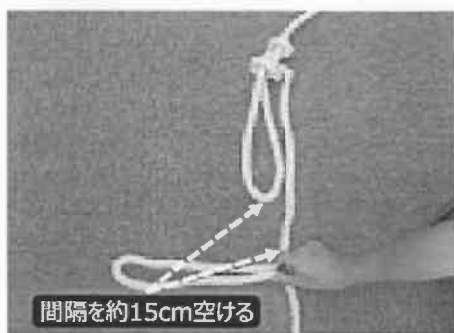
⑥ 2段目、3段目を順次作製。アイの先端から15cm空けて次のアイを作製する
