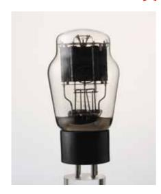
真 空 管・・・・・ 内部を高度に真空にし、電極を 封 入した中空の管球。 陰極から陽極に流れる電子流を 制御することによって増幅・検波・整流・発振などに用い、通信・エレクトロニクスなどの分野で極めて広い用途に充てられたが、現在はトランジスター・IC などの 半導体にその座を譲り、一般用にはほとんど使わなくなった、マイクロ波管・X線管など、特殊用途だけのものだけが残っている。
