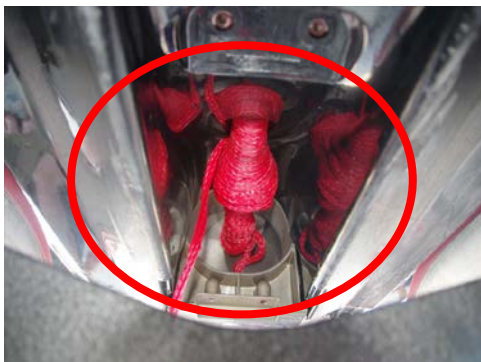
ロープを軸に巻き込んだ状況
