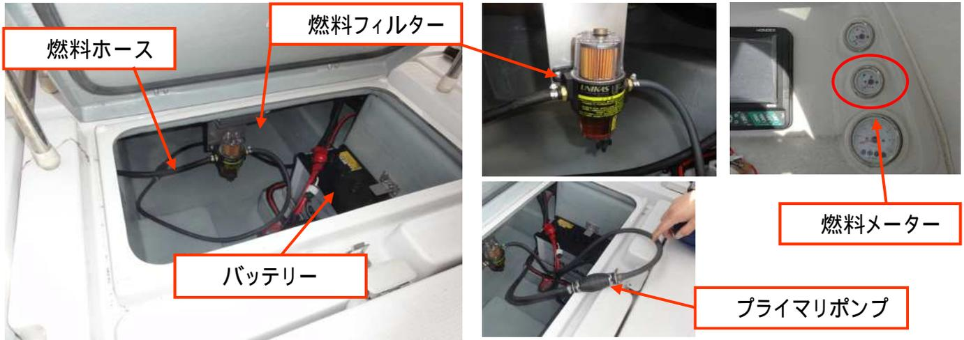
この船では、船体後部のハッチをあけると、燃料フィルター、バッテリーが設置されています。燃料タンクは船体内部に設置されています。
