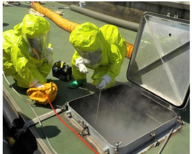
防護服を着て有害ガスの検知を行う機動防除隊員
