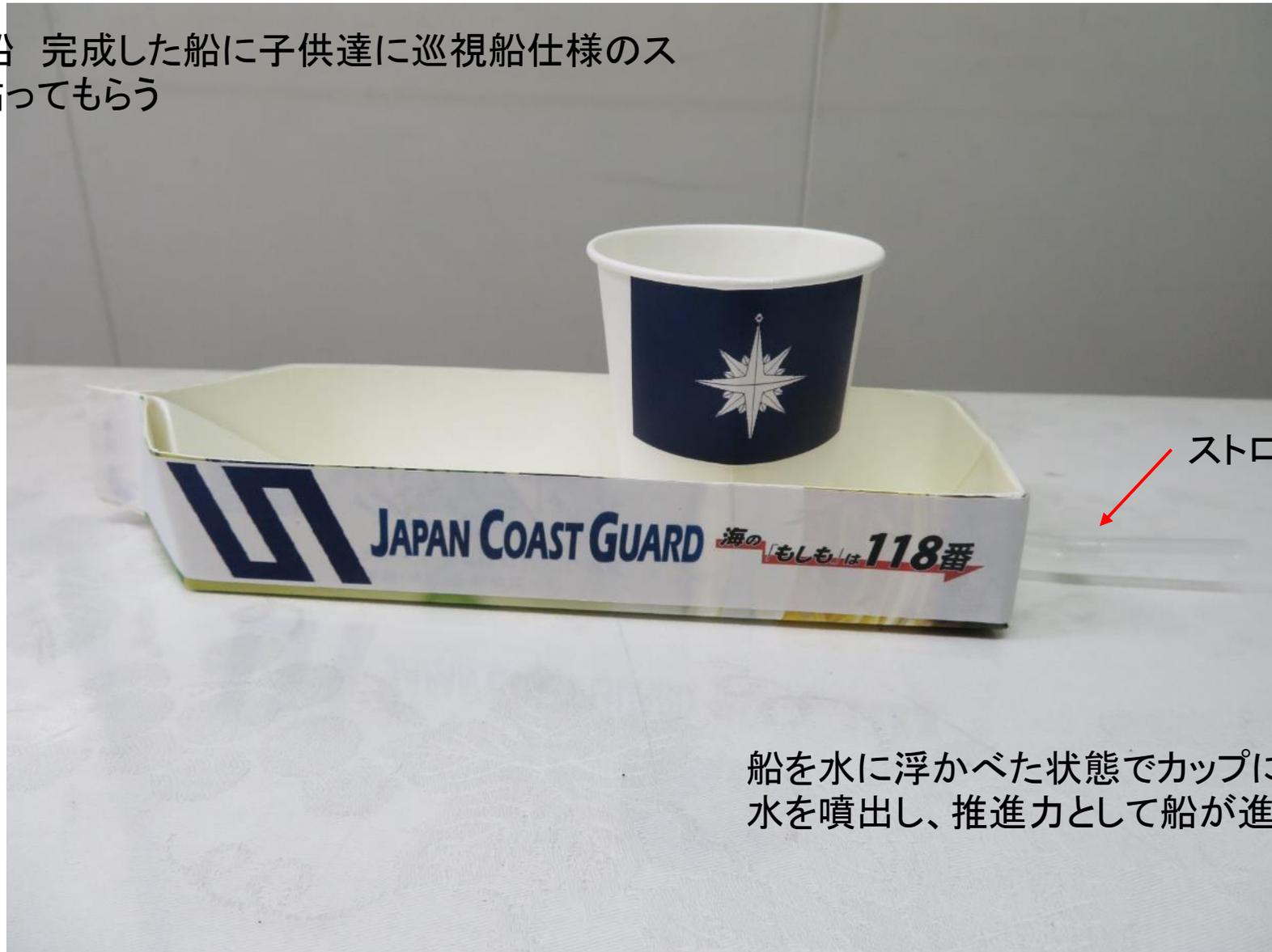
船を水に浮かべた状態でカップに水を注ぐとストローから水を噴出し、推進力として船が進みます
