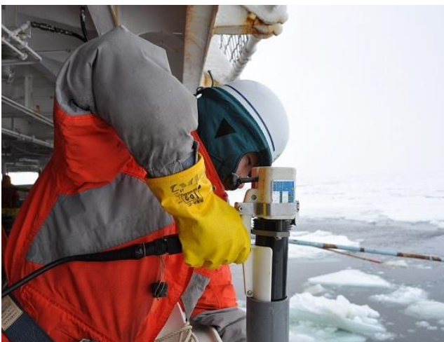
投下式水深水温塩分計による調査
