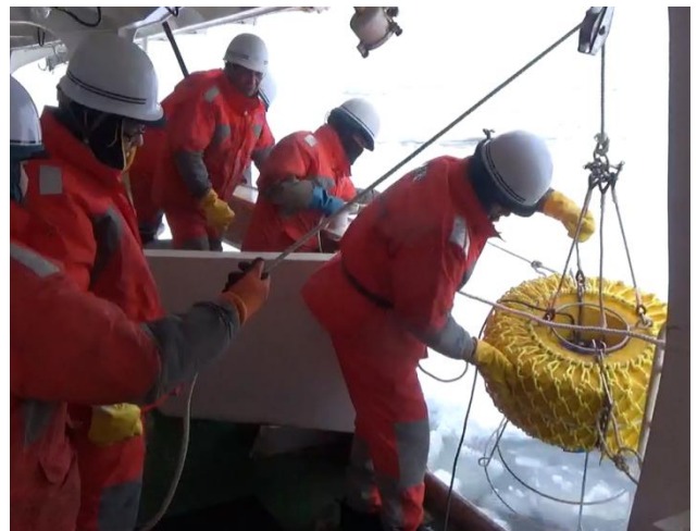
超音波式流向流速計による調査
