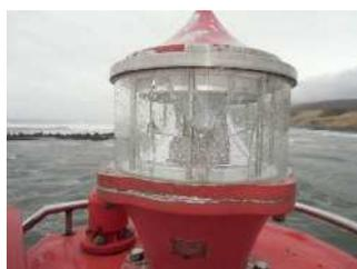
波浪によりLED灯器が破損
